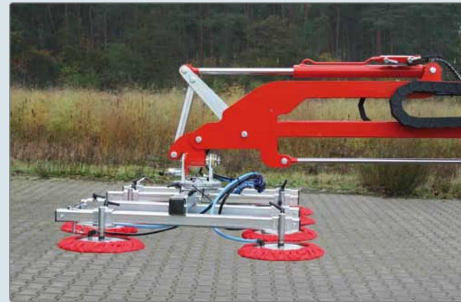
▲ Spezial-Dreh-Knick-Gelenk für elektrisches Schwenken von der Horizontalen auf Überkopf-Position
