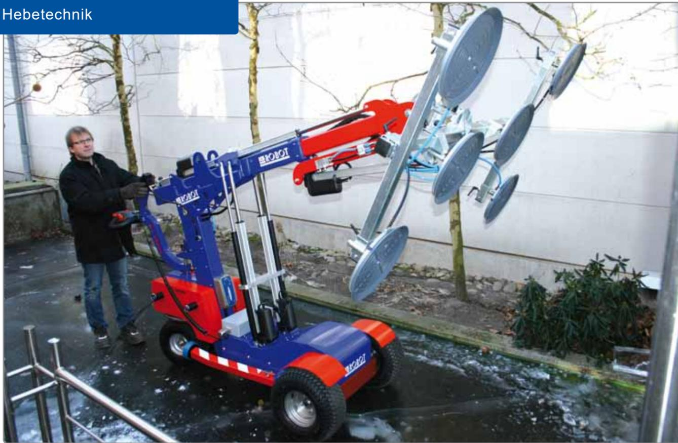
KS Robot 600 Offroad im Härtestest - sogar auf Eis macht er eine gute Figur. Ein zugefrorener Teich ist der einzig mögliche Zugang, um Glasreparaturen an der Dachverglasung vorzunehmen.
