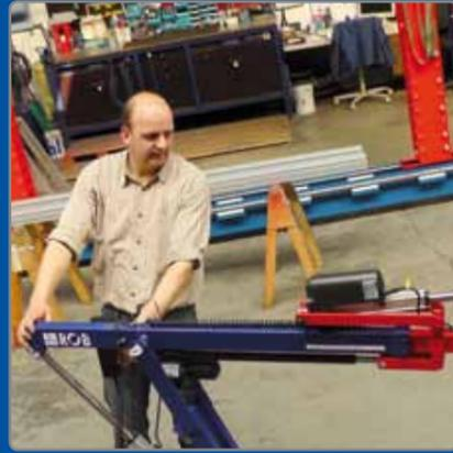
Der Teleskoparm wird eingesteckt und der Liniarzylinder angeschlossen.
