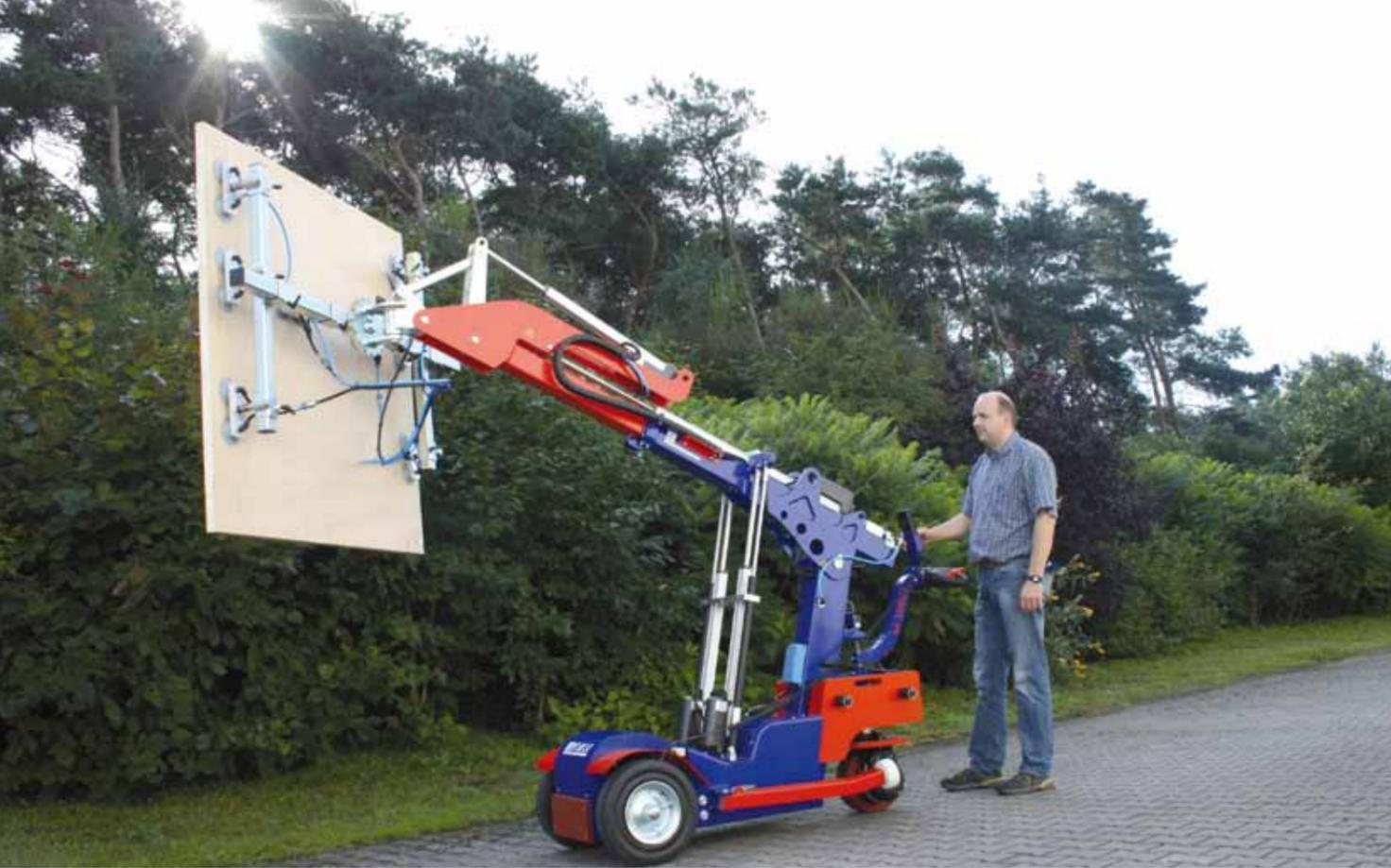
KS Robot 400 mit spezieller Vakuumsauganlage für Holzplatten.
