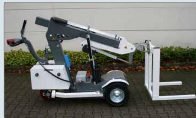
KS Robot mit Geräteträger ohne Vakuumpumpen.
