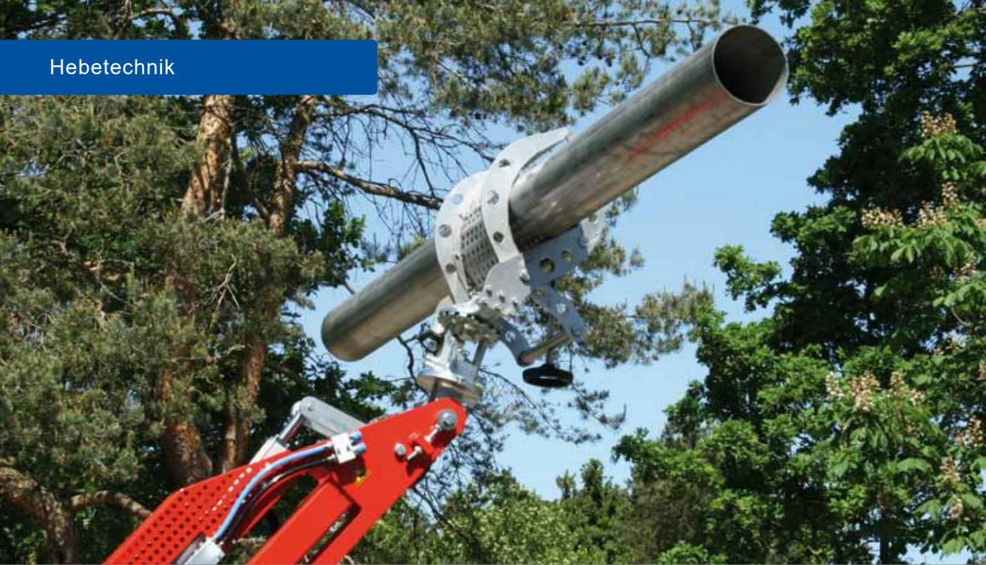
Spezialgreifer\* für Teppichrollen, Kunststoff- oder Metallrohre elektrisch und mechanisch möglich.
