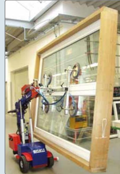
Seitliche Schwenkfunktion für den Transport bei beengten Platzverhältnissen.
