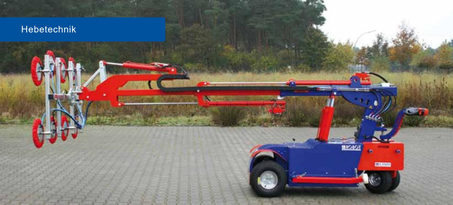
▲ Hydraulischer Doppelteleskop für 2 x 1.000 mm Ausladung
