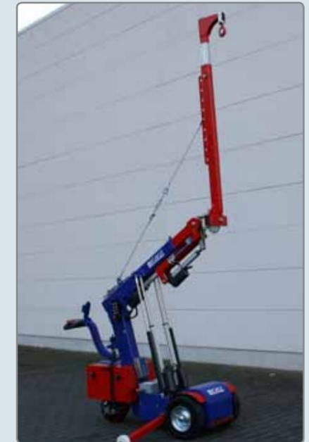
Zusatzarm für die Aufnahme von Bauwinden.
