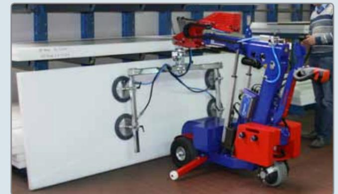
KS Robot zur Plattenentnahme aus Regalfächern.
