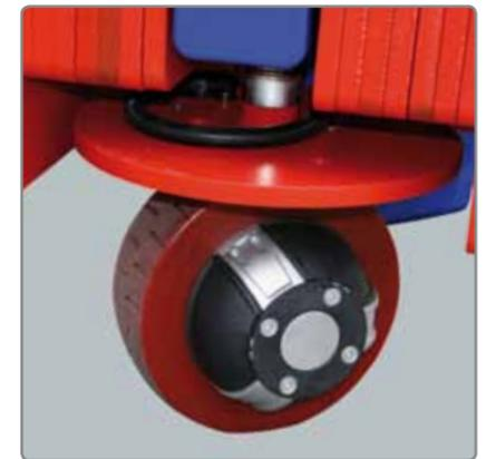
Der drehbare Hinterreifen ermöglicht einen kleinen Wendekreis (360°).
