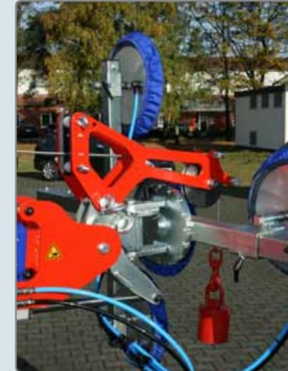
KS Robot mit Seilwinde und Vakuumsauganlage.
