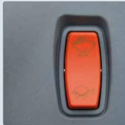
Taster zum Einstellen von zwei verschiedenen Fahrgeschwindigkeiten.
