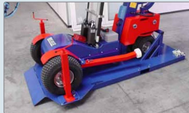
Stapleraufnahme-Vorrichtung für den KS Robot Offroad.
