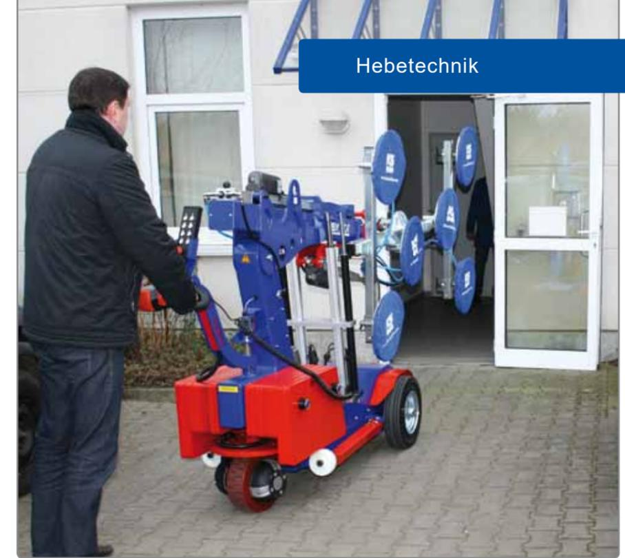
Sehr gelenkig: 90° Schwenkeinheit kippt die Sauganlage seitlich für Fahrten inklusive Last durch schmale Eingänge.
