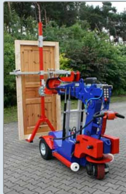
KS Robot mit Aufnahmevorrichtung für Türen.
