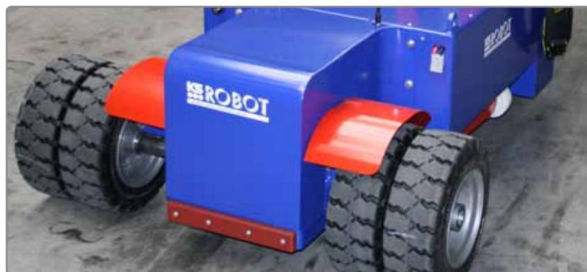
Achsenverstellung zur genauen Positionierung der Glasscheiben und Zwillingbereifung für eine sehr gute Standfestigkeit.
