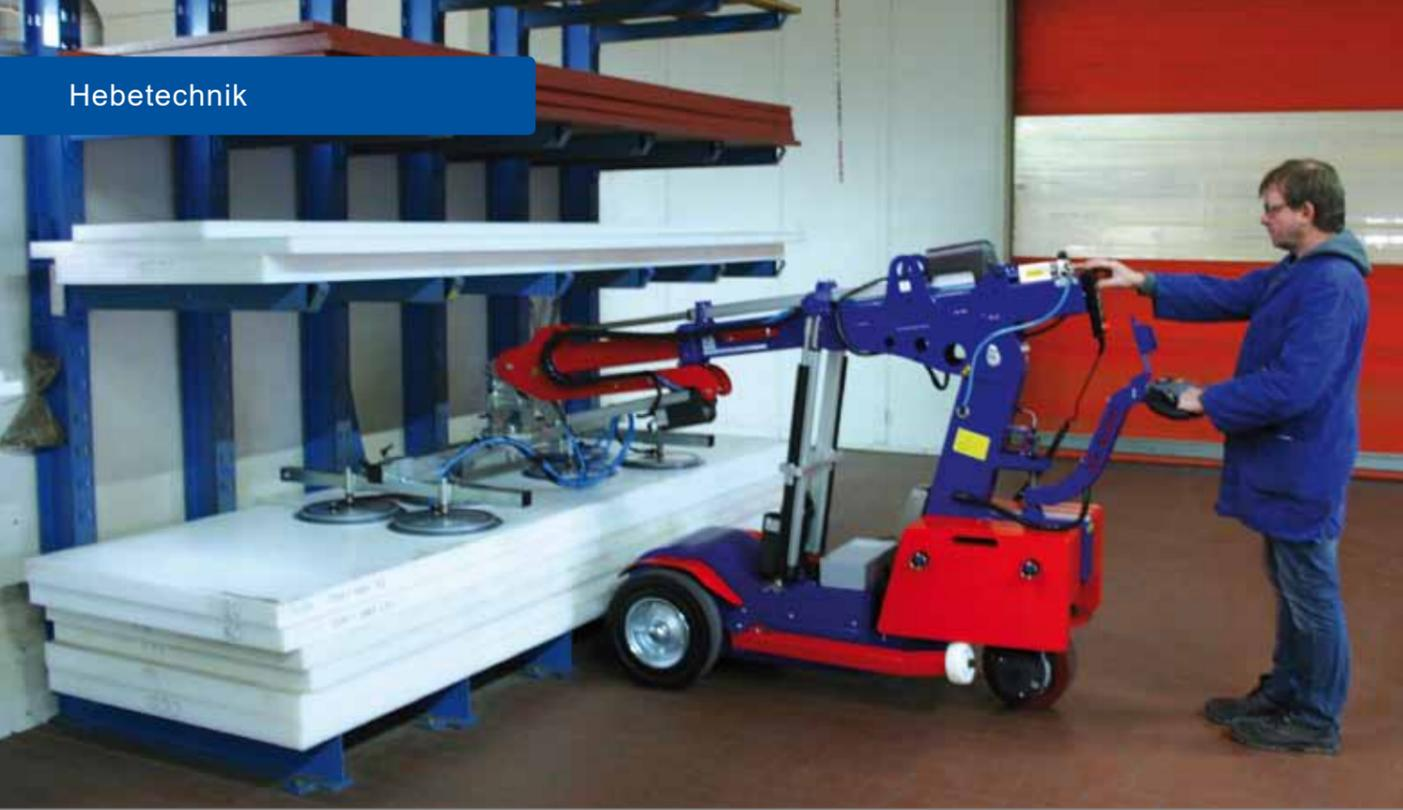
Extraklasse: Elektrisches Dreh-Knick-Gelenk ermöglicht die Aufnahme von schweren Platten direkt aus dem Regal.
