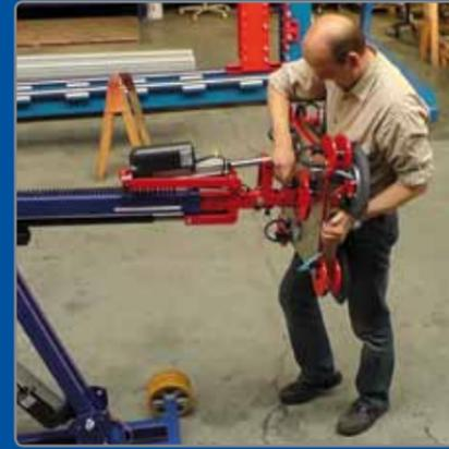
Die Vakuumsauganlage wird aus Sicherheitsgründen verschraubt.
