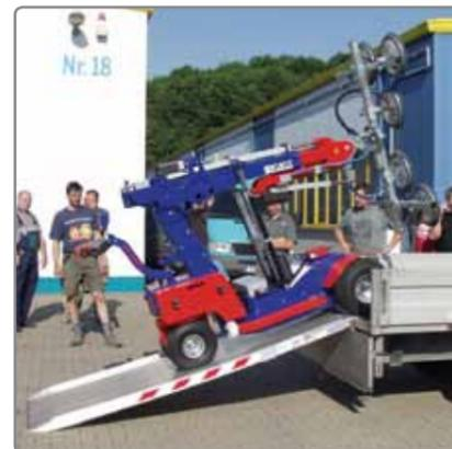
Bequem: Über die Auffahrrampe\* lässt sich der KS Robot schnell verladen und mit zur Baustelle nehmen.
