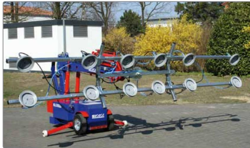
KS Robot 1000 mit Vakuumsauganlage für gebogenes Glas\*.
