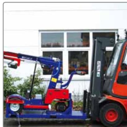
Sehr praktisch: die Gabelstapleraufnahme\* für Arbeiten auf höheren Etagen und für einen sicheren Transport.
