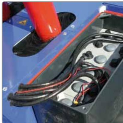
Ausstattung mit austauschbarem Hochleistungsakku für den Einsatz im Schichtbetrieb.
