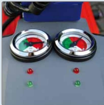
Kontrollanzeige gibt die Leistung der Sauganlage an und warnt vor Vakuumverlust.
