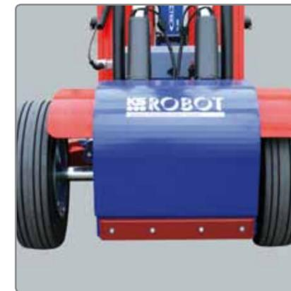
Seitliche Verschiebung von bis zu 100 mm zum Feinjustieren der Scheibe bei der Montage.
