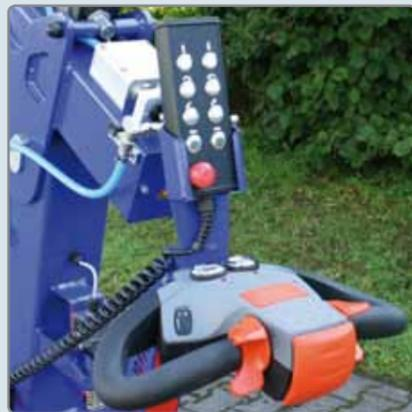
Kabelgebundene Fernbedienung und Multifunktionslenkrad erhöhen den Bedienkomfort.
