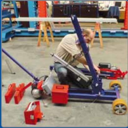
Fahrwerk, Achse und Hubmast werden im ersten Schritt montiert.
