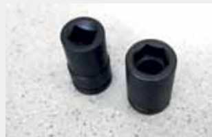
Schraubkopf RK 24 x 28 für Rechtkant, Schraubkopf SW 39 für Sechskant
