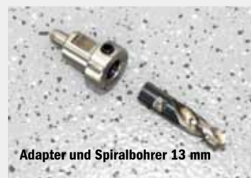
Bohrer, Adapter, Kühlmittel-Auswerferstift
