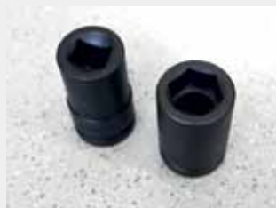
Schraubkopf RK 24 x 28 für Rechkant, Schraubkopf SW 39 für Sechskant
