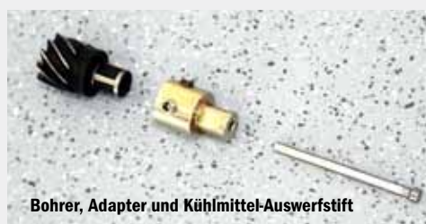
Adapter und Spiralbohrer 13 mm
