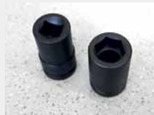
Schraubkopf RK 24 x 28 für Rechtkant, Schraubkopf SW 39 für Sechskant
