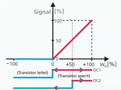
Anmerkung: Bei unidirektionaler Auslegung dient der Schaltausgang OC1 per „default“ (konfigurierbar) als Strömungsindikator. Er zeigt eine Strömung größer 0 m/s eindeutig durch Sperren an und schaltet durch, wenn sie kleiner oder gleich 0 m/s beträgt. Pfeile in der Darstellung der Schaltausgänge bedeuten, dass der Schwellwert konfigurierbar ist. Die Werkseinstellung für Schaltausgang OC2 ist 50 % vom Messbereich (Option: kundenspezifischer Schaltpunkt).
