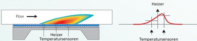
Über dem „Heizer“ wird eine Wärmeglocke erzeugt, die dann von der Strömung bewegt wird. Links und rechts vom Heizer messen zwei Temperaturfühler die Mediumtemperatur. Aus den sich ergebenden Messunterschieden wird dann die Strömungsgeschwindigkeit ermittelt. Aus der Detektion des wärmeren Bereichs erkennt der Sensor die Strömungsrichtung (optional).
