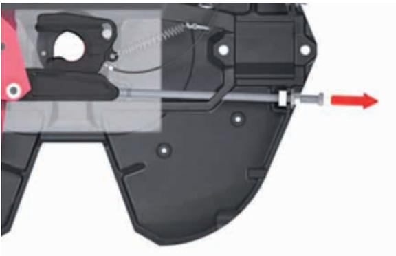
Leicht austauschbarer Verschleißring ohne Demontage der Sattelkupplung.
