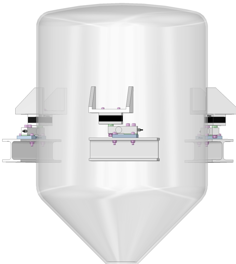
Silo a 3 punti di appoggio.
